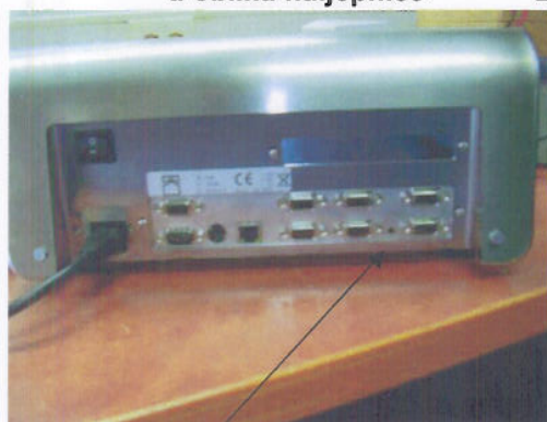
ulaz k kalibracionom prekidaču
